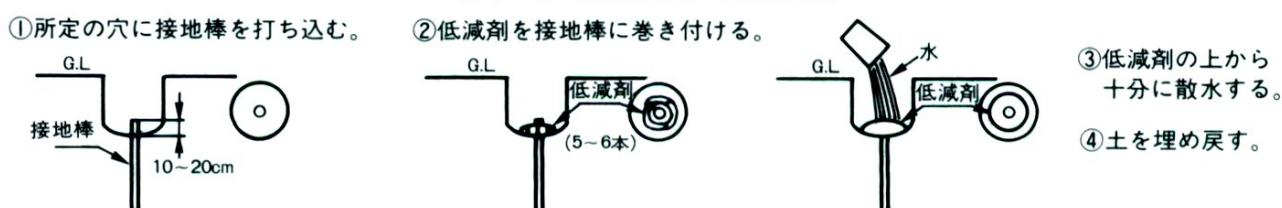
[図-2] 接地棒との併用工法
