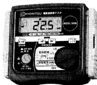
図-4 漏電遮断器テスタ
