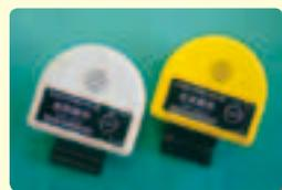
特長は3つあります。1つ目は、本器が在来線 AC20kV、新幹線 AC25kV から約2m離れた位置から「非接触」で充電状態を検出して、作業者にブザーでお知らせする点。2つ目は、充電状態の電車線を特定するため「検出の指向性」を有する点。3つ目は、小型軽量でヘルメットにワンタッチ取付けが可能な点。これらの特長から、ヒューマンエラーによる感電事故を未然に防ぐことができます。
