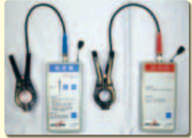
対象ケーブルに送信器のクランプ式CTを取付け、信号を印加すると回り込み等で他のケーブルにも信号がかかりますが、対象ケーブルに最も強い信号がかかるようになります。受信器のセンサをクランプまたはケーブルに接触させ信号の強弱を比較しますが、受信器は対象ケーブルにかかる最も強い信号に対して感度の自動調整を行うため、対象外のケーブルに信号の回り込みが生じる条件であっても確実に対象ケーブルを特定することができます。信号印加はクランプ式CTを採用することで、非接触での信号印加が可能となり、作業性の大幅な改善が期待できます。
